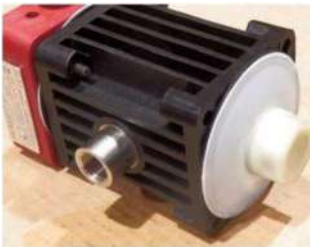
Шаг 4 Снимите корпус насоса
