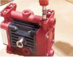
Шаг 1 Разберите напорный коллектор раскрутив винты
