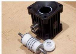
Шаг 7 Удалите воздушный клапан с центрального блока
