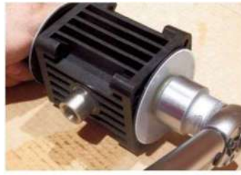
Шаг 5 Разберите диафрагмы раскрутив внешние крышки удерживающие диафрагмы и снимите диафрагмы и внешние поршни
