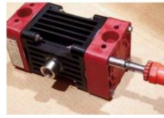
Шаг 3 Разберите корпус насоса, раскрутив винты
