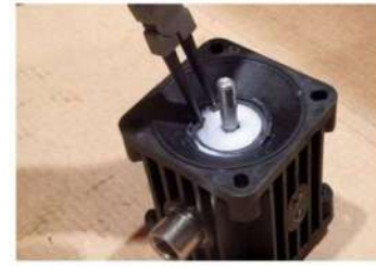
Шаг 6 Разберите стопорное кольцо воздушного клапана
