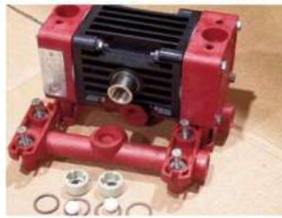
Шаг 2 Снимите напорный коллектор, седла, шарики и кольца клапанов. Выполните ту же процедуру (шаги 1 и 2) чтобы удалить также всасывающий коллектор
