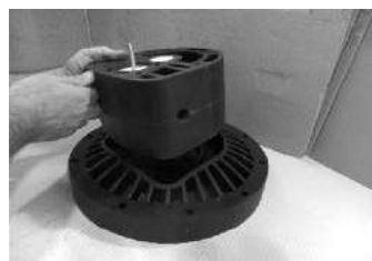
ШАГ 3 Установить фланцы в воздушные камеры
