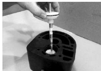
ШАГ 3а Снять обе крышки и вал воздушного клапана с противоположной стороны
