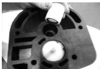
ШАГ 1 Установить подшипники внутри центрального блока
