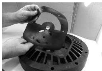
ШАГ 4 Скрепить центральный блок с воздушными камерами
