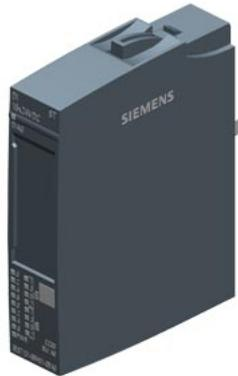
SIMATIC ET 200SP, Digitales Eingangsmodul, DI 16x 24V DC Standard, Eingangstyp 3 (IEC 61131), Sink Input, (PNP, P-Iesend), Verpackungseinheit: 1 Stück, passend für BU-Typ A0, Farbcode CC00, Eingangsverzögerung 0,05..20ms; Modul-Diagnose für: Drahtbruch, Versorgungsspannung
